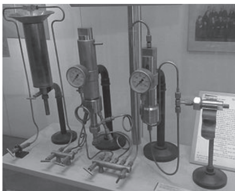
Figura 3.4 | Aparelho de bancada que Haber utilizou para desenvolver o processo de síntese da amônia
