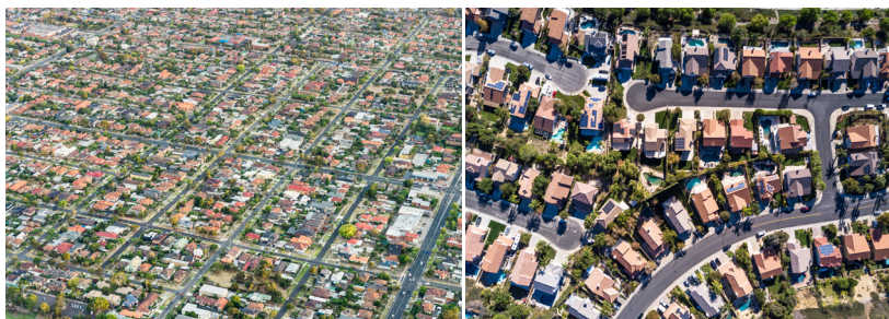
Figura 1.2 | Tecido urbano com traçado viário fechado e ortogonal (esquerda) e tecido urbano com traçado aberto (direita)
