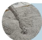
**Concreto:** material durável e adaptável a diversas formas geométricas, tem uma baixa porosidade e elevada resistência à compressão, mas uma baixa resistência à tração. Juntamente com o aço, é o material de construção civil mais utilizado no mundo, tendo o melhor custo-benefício para edificações convencionais.
