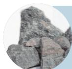
**Rocha:** usada nas construções até hoje, na forma de pedra britada. Antigamente era utilizada nas construções pelas suas características de durabilidade e pela possibilidade de ser lapidada, sendo empregada na construção de templos e esculturas. Porém, possui um elevado peso e por esse motivo é difícil de manuseá-la.
