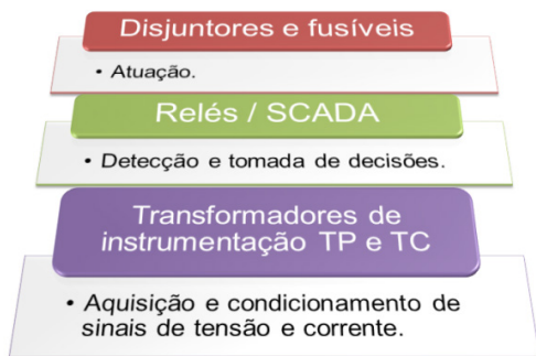
Figura 1.2 | Estrutura básica de um sistema de proteção
