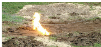
Figura 3.10 | Arco formado em terra seca
