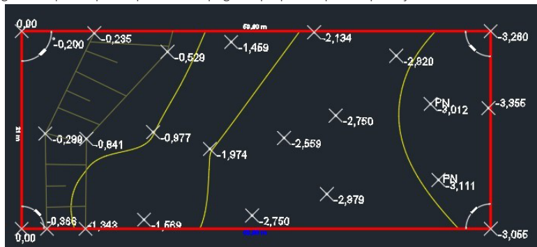
Figura 2.9 | Exemplo de planta de topografia preparada para importação no Revit
