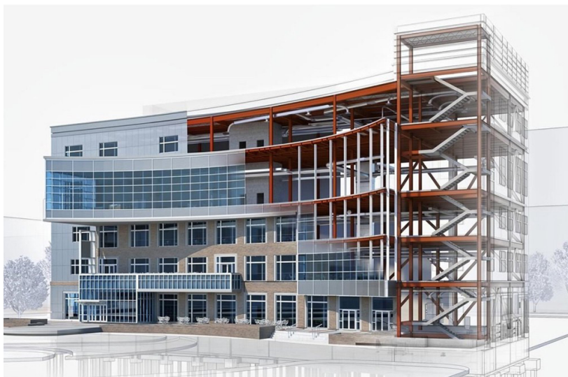
Figura 2.2 | Modelo de edifício que ilustra todos os seus componentes estruturais
