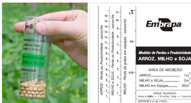
Figura 3.12 | Método de avaliação de perdas utilizando copo medidor
