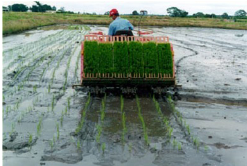
Figura 2.5 | Sistema de transplantio de arroz
