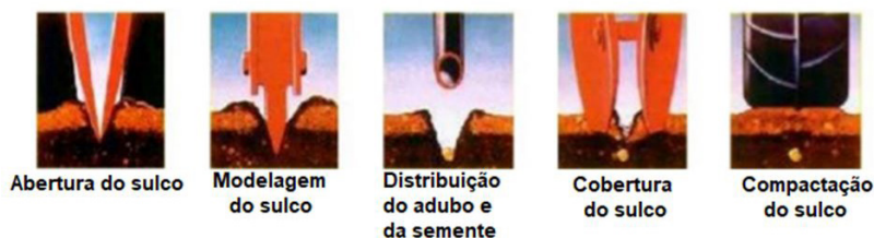
Figura 3.7 | Esquema de semeadura sob sistema de plantio direto ou cultivo mínimo
