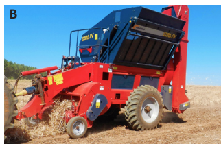
Figura 3.10 | Colheita semimecanizada de feijão A) trilhadora estacionária para feijão B) Recolhedora trilhadora para feijão
