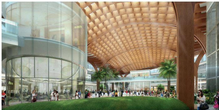
Figura 3.2 | Estrutura em madeira laminada colada no Shopping Iguatemi Fortaleza
