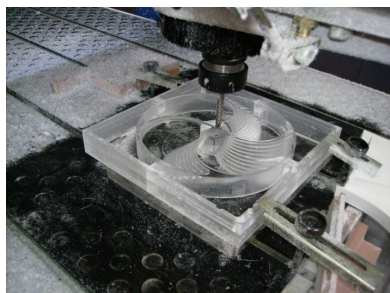
Figura 4.4 | Detalhe de uma peça sendo produzida em plástico e Fresa A4
