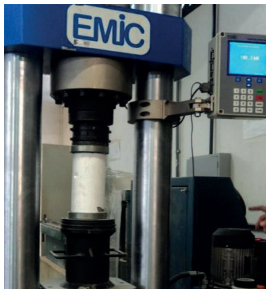
Figura 4.12 | Configuração geral do ensaio de compressão
