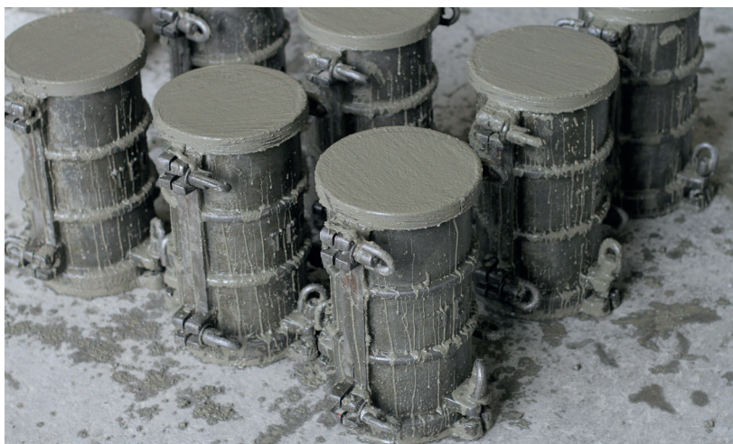
Figura 4.10 | Corpos de prova de concreto dentro do molde metálico
