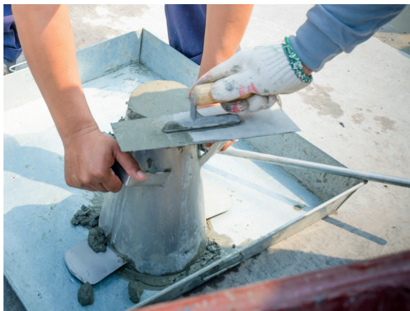
Figura 4.13 | Moldagem do concreto para slump test
