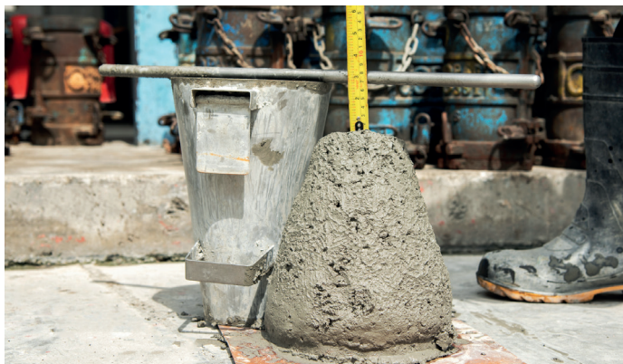
Figura 4.14 | Medida do abatimento do tronco de cone
