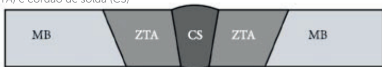
Figura 2.2 | Desenho esquemático do metal base (MB), zona termicamente afetada (ZTA) e cordão de solda (CS)
