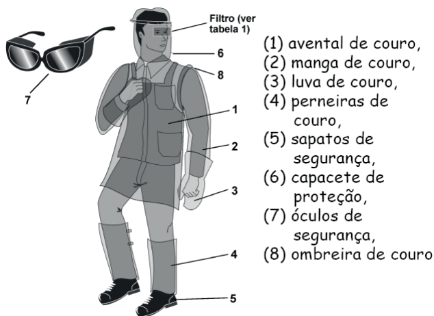
Figura 1.10 | Desenho esquemático da utilização de EPI para soldagem
