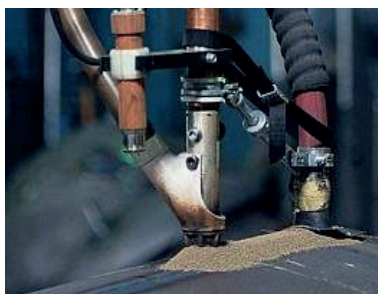
Figura 3.17 | Máquina de soldagem a arco submerso em operação
