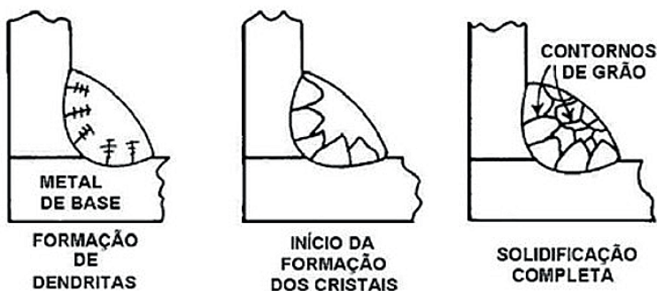
Figura 3.21 | Processo de solidificação de uma junta soldada
