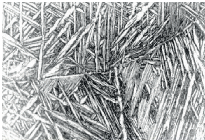
Figura 3.25 | Microestrutura martensítica de uma solda de aço carbono
