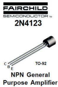
Figura 2.12 | Identificação e aparência do 2N4123
