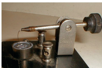
Figura 1.1 | Detector de ondas de rádio com cristal de galena: (a) foto; (b) esquemático
