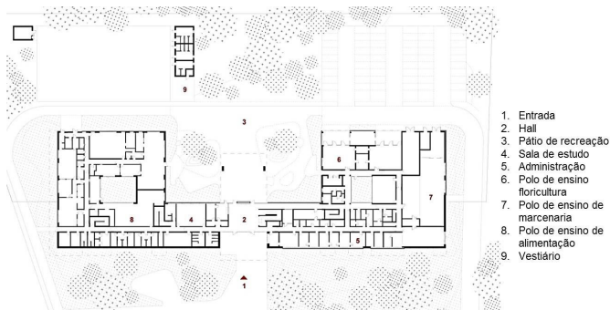
Figura 3.15 | Planta Pavimento Térreo
