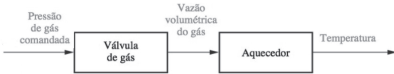
Figura 2.11 | Diagrama de blocos de um aquecedor a gás
