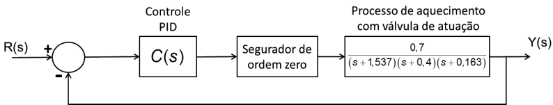
Figura | Malha de controle com PID digital
