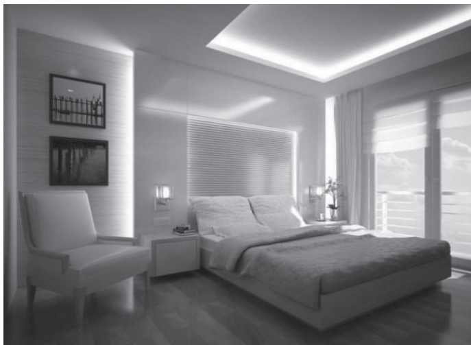
Figura 2.6 | Exemplo de iluminação em dormitório com luz geral indireta por meio de sancas de gesso e abajures para leitura
