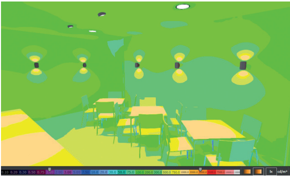
Figura 4.14 | Representação gráfica com codificação de cores (cores falsas) gerada pelo software DIALux
