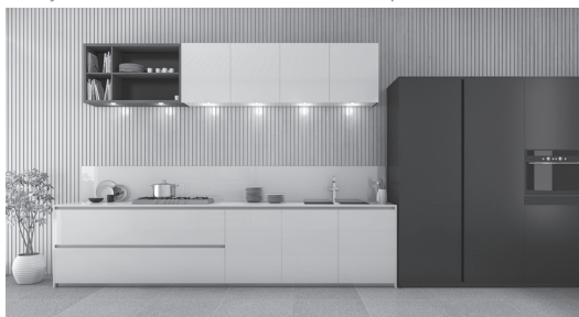
Figura 2.17 | Posição da luminária em cozinhas: na parte inferior do armário
