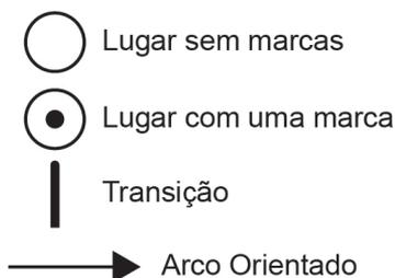
Para um melhor entendimento, vamos discutir sobre uma RdP simples. Imagine que você precise modelar um processo em que existem peças em um *buffer*, que essas peças são trabalhadas em uma célula de montagem e, por fim, são depositadas em um *buffer* de saída. Como poderíamos modelar esse simples processo em uma RdP?
