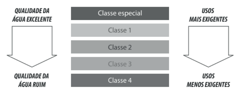
Figura 4.2 | Esquema da relação entre a qualidade da água, a adequação dos usos e as classes de enquadramento dos corpos hídricos
