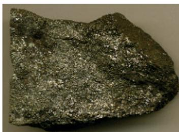
A) Rocha ígnea alcalina (rocha encaixante, formada por minerais claros e escuros) com veio de molibdenita ( $\text{MoS}_2$ ), um mineral fonte de molibdênio (Mina Climax, Colorado – EUA).
