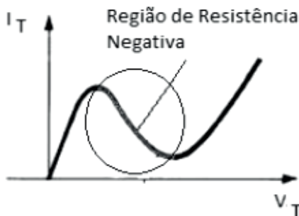
Figura 1.23 | Curva característica de um diodo túnel
