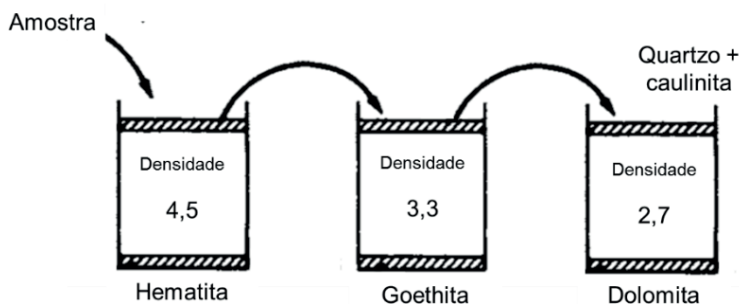
Figura 3.11 | Esquema de separação de fases de um minério de ferro utilizando líquidos densos
