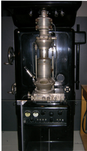
Figura 1.12 | O primeiro microscópio eletrônico, construído por Ernst Ruska em 1931
