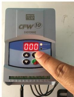
3. Os ajustes de valores serão feitos pelas teclas com setas. Observe se o led está na cor verde indicando a função "Valores"; após os ajustes, teclar P novamente para confirmar.
