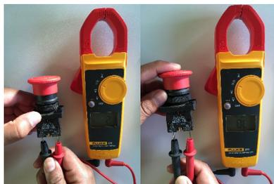
Sinaleiros luminosos e sonoros: para verificar o real funcionamento, é importante a energização destes componentes conforme a tensão elétrica informada neles.
