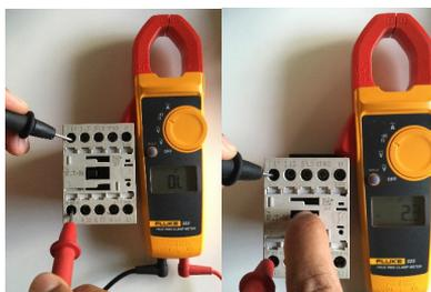
Relé de sobrecarga: idem ao disjuntor motor, porém, além do ajuste da corrente de operação, ajustamos o modo de operação entre manual e automático. Também é necessário verificar se os contatos de comando estão comutando.
