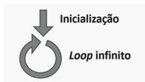
Figura 1.16 | Estrutura básica de programas para sistemas embarcados
