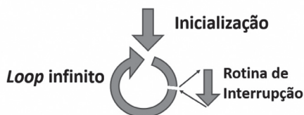
Figura 3.10 | Estrutura básica de um programa embarcado, para uma realização do ciclo
