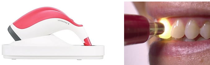
Figura 1.8 | Aparelho Easyshade - VITA®: seleção automática (objetiva) da cor dos dentes
