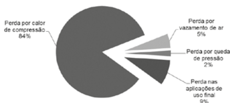
Gráfico 3.5 | Perdas características de sistemas de ar comprimido
