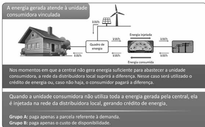
Figura 2.3 | Sistema de compensação de energia elétrica
