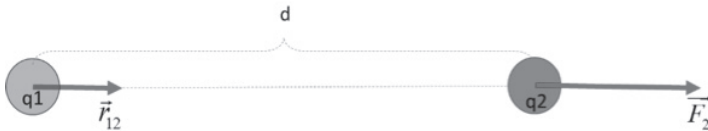
Figura 2.1 | Força eletrostática sentida pela partícula q_2 , devido ao campo elétrico gerado pela partícula q_1
