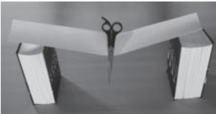
Figura 3.79 | Biapoio sem fixação com "barriga" para baixo: peso de uma tesoura
