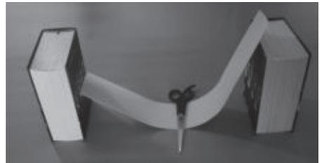
Figura 3.80 | Biapoio com uma fixação com "barriga" para baixo: peso de uma tesoura
