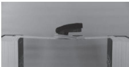
Figura 3.88 | Régua sustenta grampeador sem sofrer deformação
