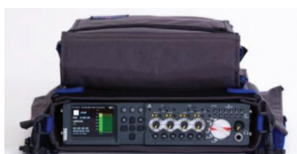
Figura 3.6 | Gravador digital com memória flash interna nagra VI
