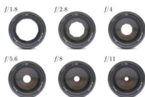
Figura 3.3 | Lentes com algumas aberturas de f-stops
