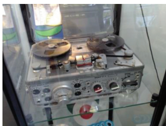
Figura 3.5 | Gravador analógico de rolo nagra IV-S
