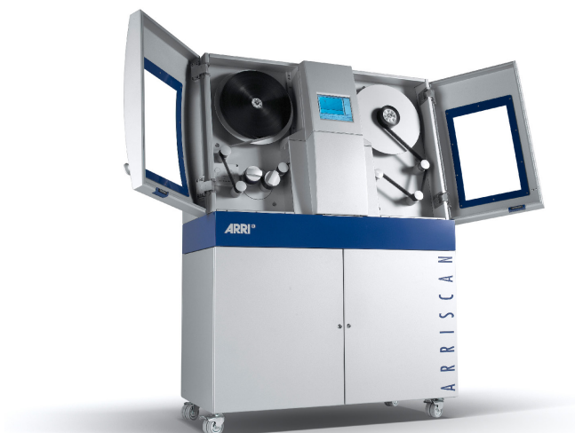
Figura 4.7 | Scanner para video transfer , da película para o vídeo, ArriScan
