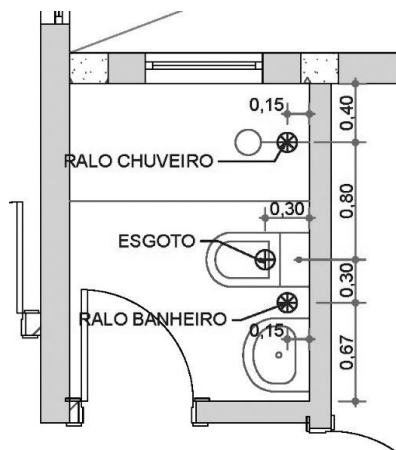
Figura 2.7 | Planta de pontos hidráulicos
