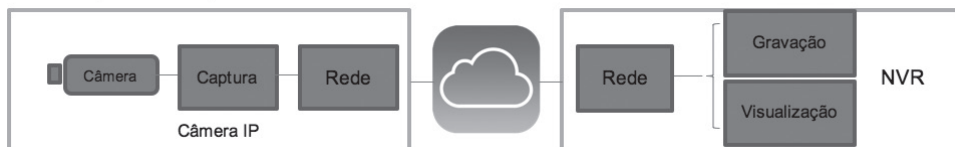
Figura 3.8 | Esquema de funcionamento de uma câmera IP
