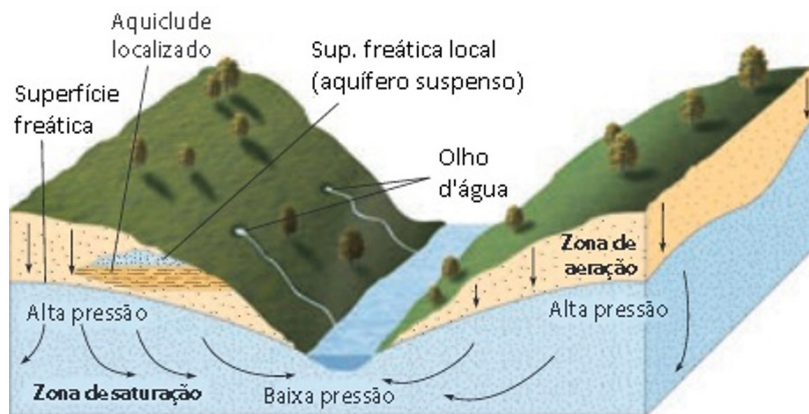
Figura 2.12 | Movimento da água subterrânea, sup. freática (principal e local) e olhos d'água em uma região de vales
