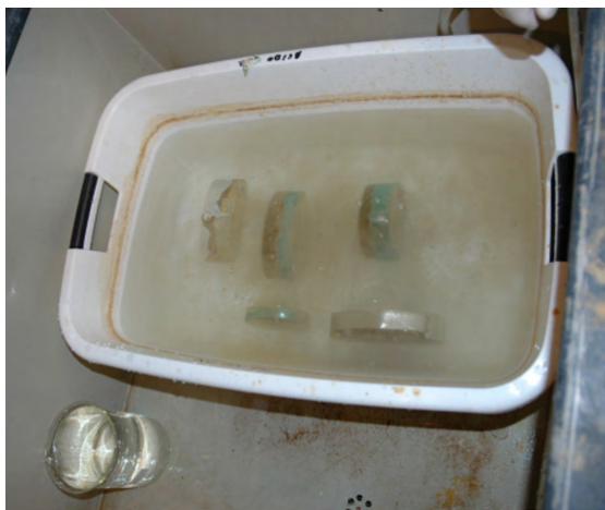
Figura 4.9 | Exemplos fósseis imersos em uma solução contendo ácido diluído
