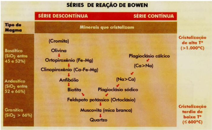
Figura 1.10 | Série de Bowen, que demonstra a ordem de cristalização dos minerais dos magmas segundo a variação de temperatura
