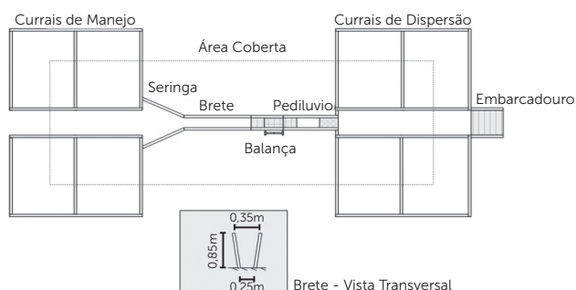
Figura 2.4 | Diagrama representando as principais instalações no centro de manejo
