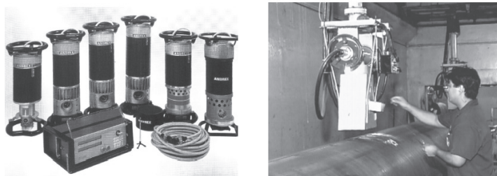
Figura 2.7 | Equipamento de radiação ionizante e inspeção radiográfica de soldas em tubos
