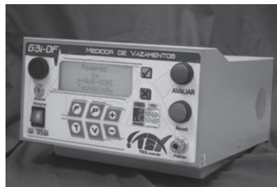
Figura 3.12 | Equipamento para teste de estanqueidade
