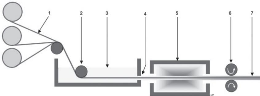
1- Fibras contínuas/tapete de fibra tecida; 2- Roleta de tração; 3- Banho de resina; 4- Fibra embebida de resina; 5- Matriz e fonte de calor; 6- Rolos de laminação; 7- Polímero reforçado com fibras.
