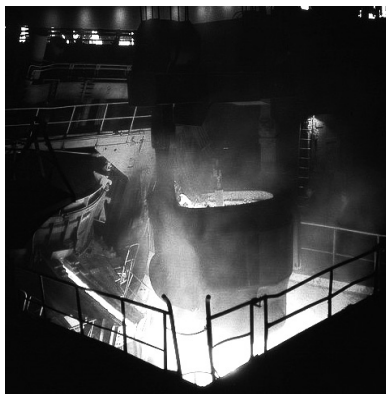
Figura 3.3 | Caldeira com aço derretido
