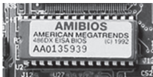
Figura 2.4 | Chip de memória com BIOS
